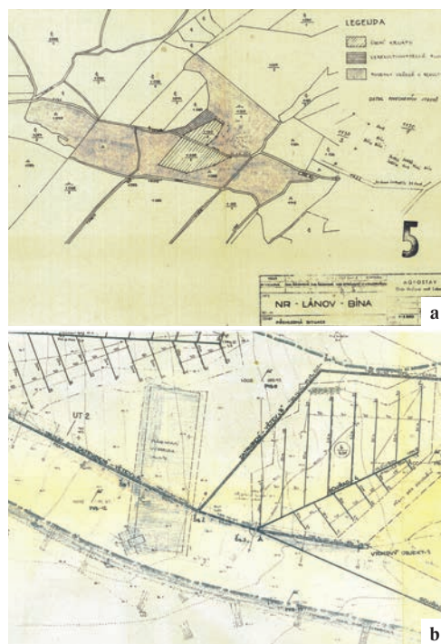
Obr. 2a, b. Lokalita Bíner – projekty melioračních zásahů z 80. let 20. století. Nahoře přehledná situace návrhu rekultivačních zásahů v okolí současné zájmové plochy ochrany přírody slatiniště Bíner (šrafovaná plocha), dole detail realizované systematické trubní drenáže s „ochranným pásmem“ bez odvodnění u zájmové plochy Bíner.
